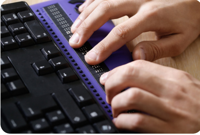
Şekil 3. Bilgisayar klavyesine eklenebilen braille klavye.
